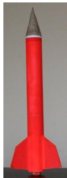
モデルロケット 直径 60mm 高さ 634mm
